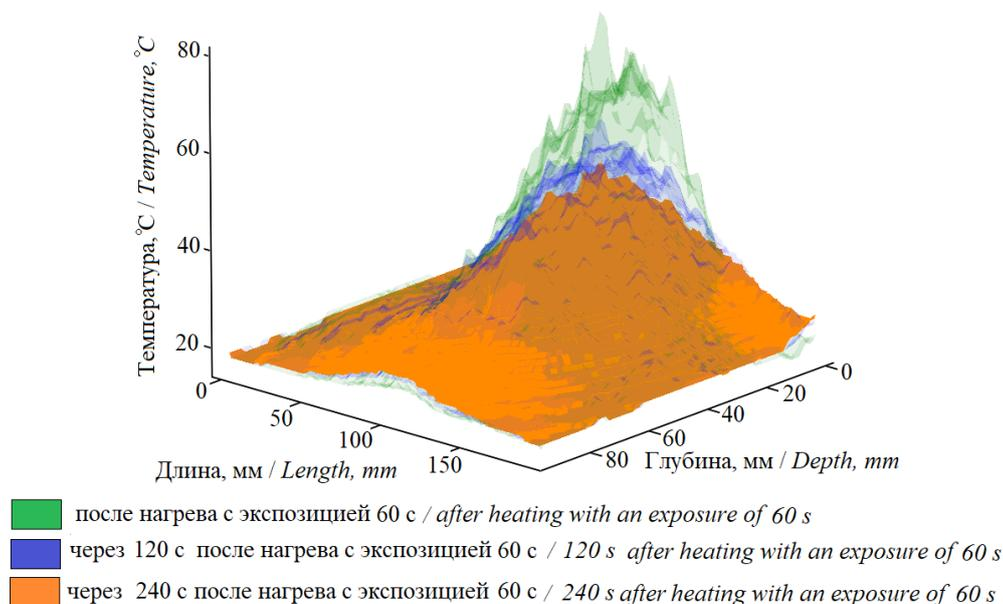
Рис. 5. Анализ термограмм динамики изменения температуры боковой поверхности образца почвы в боксе с течением времени после воздействия СВЧ-излучения
