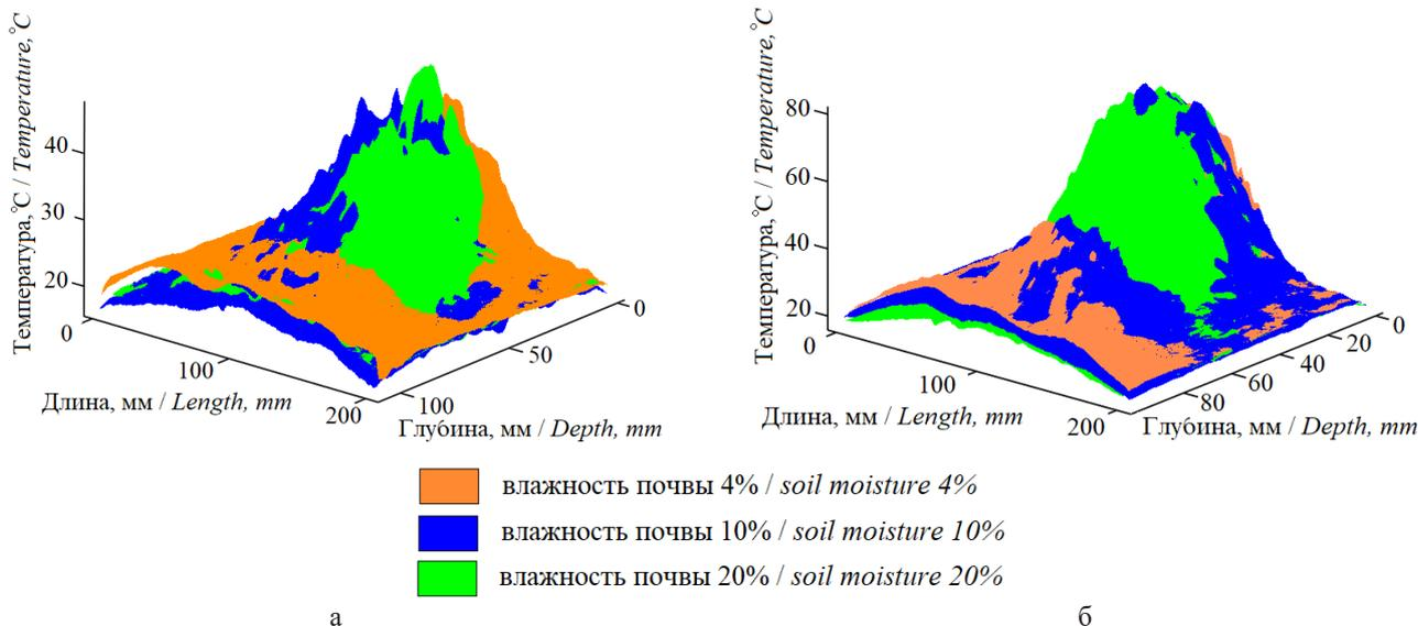
Рис. 4. Поверхность распределения температуры при влажности почвы 4, 10 и 20%:
