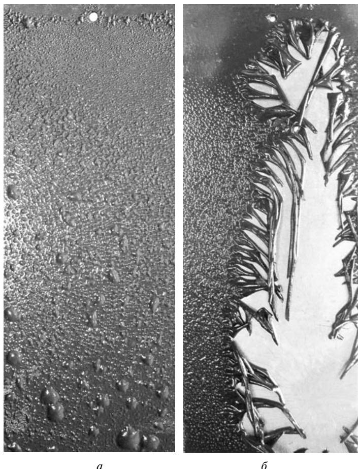
**Воздействие на образцы стали, покрытые топливостойкой фенолалкидной эмалью ФА-5278 после 3 циклов испытаний:**
