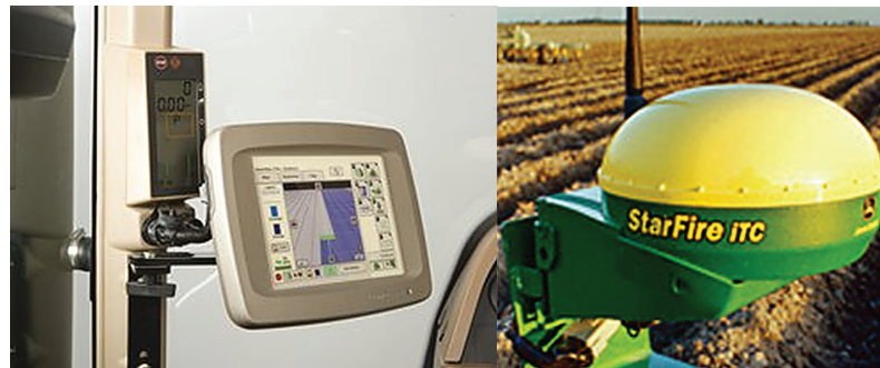
Рис. 1. Комплект автоматического вождения AutoTrac Universal 200
