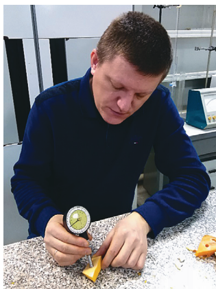
Рис. Определение твердости коры и мякоти Fig. Determination of the bark and pulp hardness
