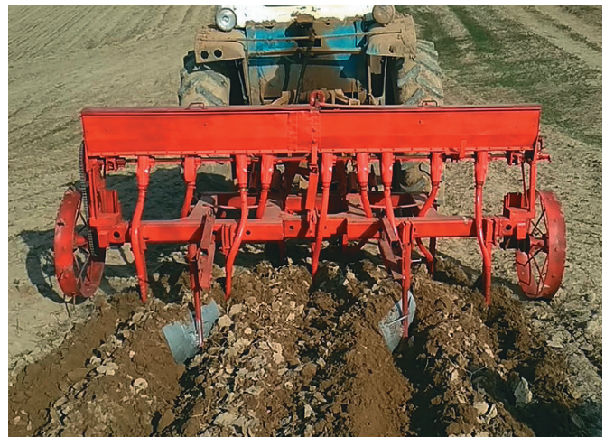
Рис. 5. Комбинированное орудие для обработки почвы и посева, работающее на склоновом поле Fig. 5. Combined tool for tillage and sowing, operating on a slope field
