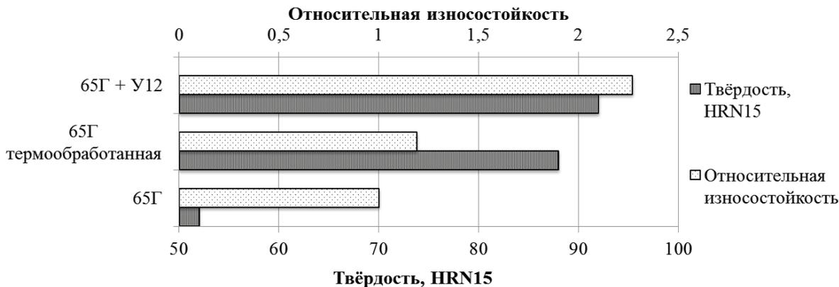
**Рис. 5. Результаты испытаний на износостойкость**
