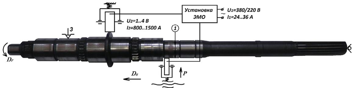
Рис. 3. Электромеханическое восстановление наружной поверхности вала
