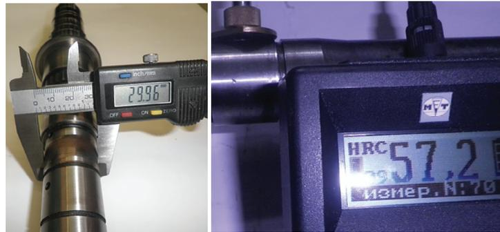
Рис. 4. Вал с изношенной поверхностью под подшипник качения (а) и исходной твёрдостью (б)
