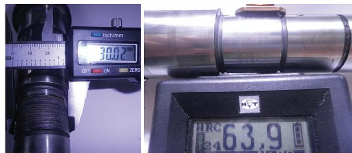
Рис. 5. Изменение размера (а) и твёрдости поверхности вала после восстановления (б)
