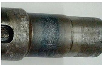
**Рис. 1. Фрагмент поверхности вала с износом под подшипник качения**
