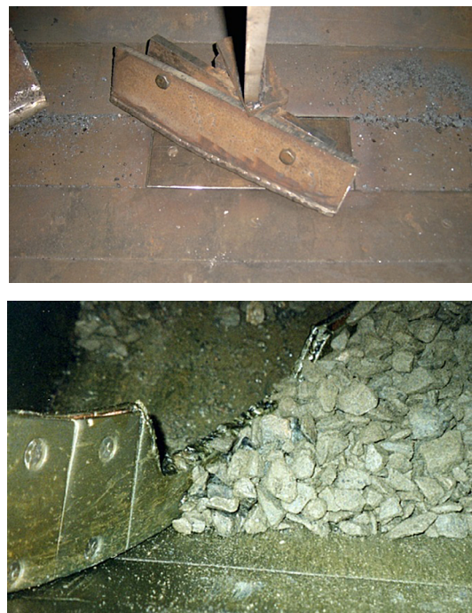
Рис. 5. Взаимодействие рабочих органов технологического оборудования с абразивной средой Fig. 5. Interaction of working elements of technological equipment with an abrasive medium
