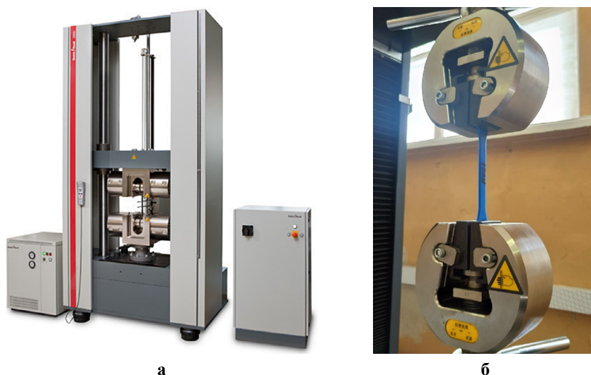
Рис. 4. Испытания на определение физико-механических свойств: а – электромеханическая разрывная машина Zwick/Roell Z100; б – образец, закрепленный в зажимах перед испытаниями
