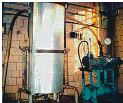
Рис. 2. Комбинированная энергосберегающая система для охлаждения молока с использованием природного холода и вакуума (ЗАО «Красногорье», Красногорский р-н Московской обл.)
