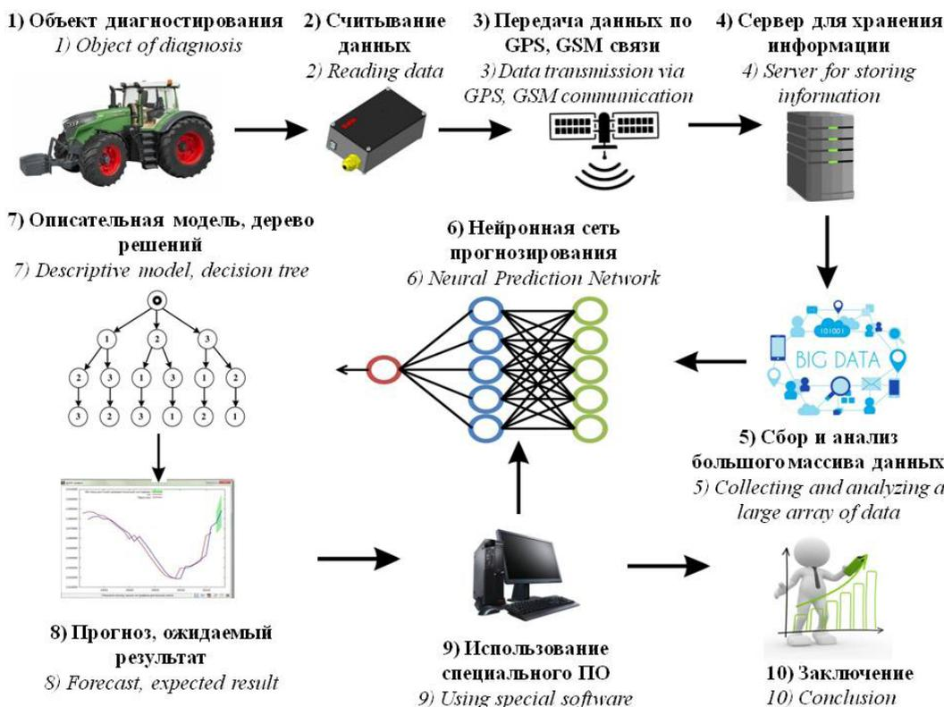
Рис. 3. Цифровая платформа по диагностированию энергонасыщенной сельскохозяйственной техники
