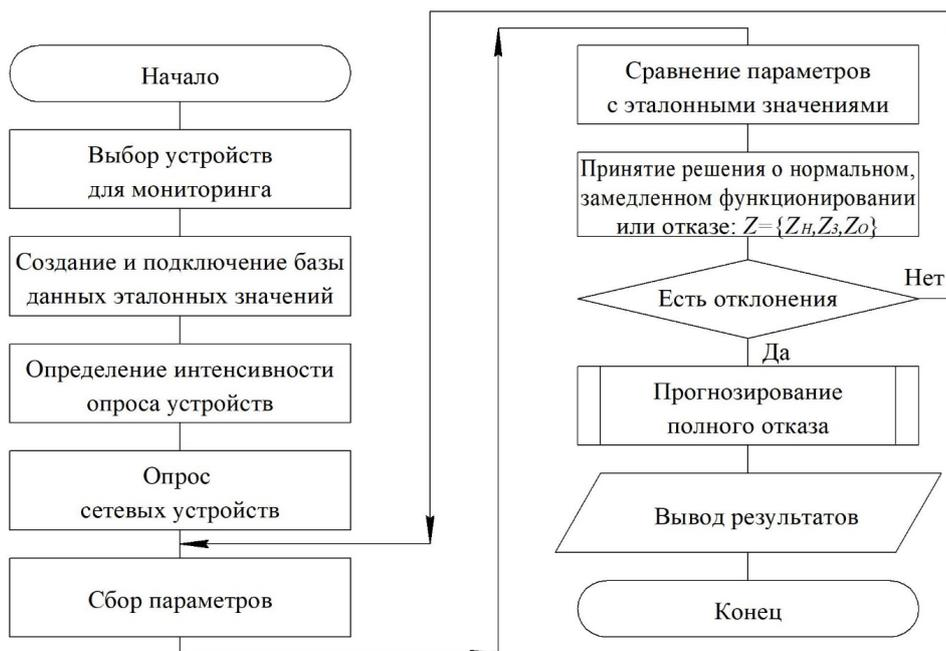
Рис. 2. Блок-схема модели прогнозирования отказов при онлайн-мониторинге
