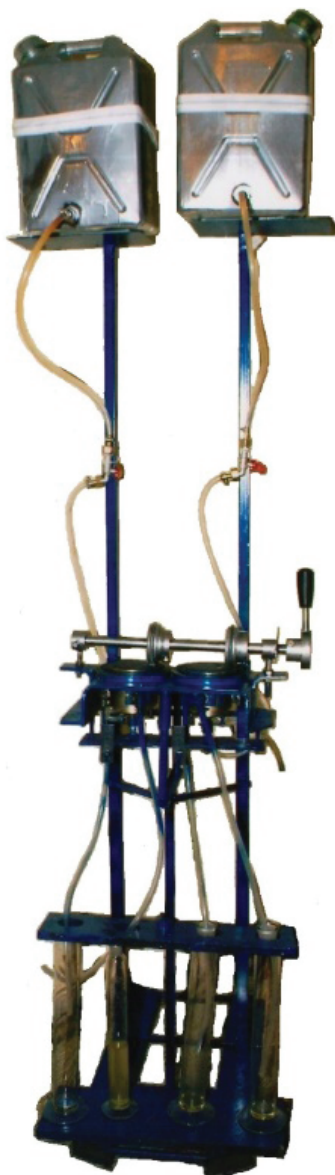
Рис. 4. Устройство смесителя для приготовления растворов различной концентрации
