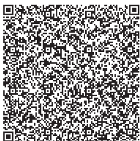
Рис. 4. Машиночитаемая маркировка в виде QR-кода с 30%-ной избыточностью Fig. 4. Machine-readable marking in the form of a QR code with 30% redundancy
