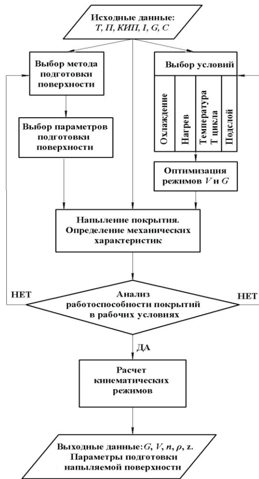
Рис. 2. Алгоритм определения параметров процесса плазменного нанесения многослойных покрытий повышенной толщины
