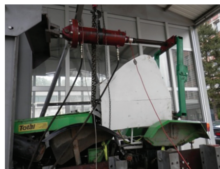
Рис. 3. Второе приложение продольной нагрузки с передней стороны защитной конструкции
