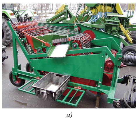
Рис. 2. Прицепной мини-комбайн КСК-1 «Кабан»: а) общий вид; б) технологическая схема: 1, 2 – элеватор; 3 – барабан; 4 – ролик; 5 – отражатель Fig. 2. Trailed mini-harvester KCK –1 “Kaban”: a) general view; b) flow chart: 1, 2 – an elevator, 3 – a drum; 4 – a roller; 5 – a reflector
