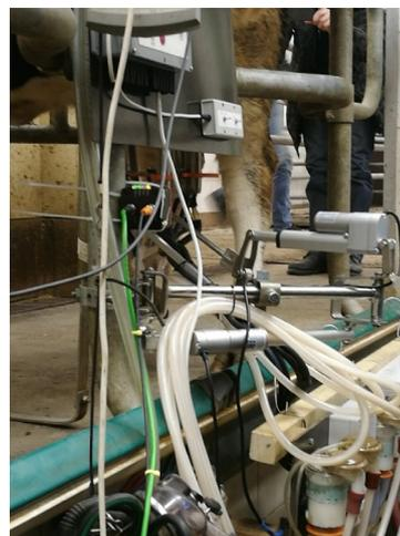
**Рис. 3. Апробация автоматизированного доильного модуля с почетвертным управлением процессом доения на ферме РГАУ-МСХА им. К.А. Тимирязева**
