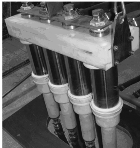
Рис. 1. Технологическая оснастка для оксидирования блоков цилиндров в проточном режиме
