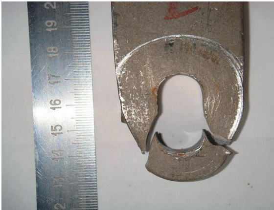
Рис. 3. Пример разрушения проушины под нагрузкой от вала [4]
