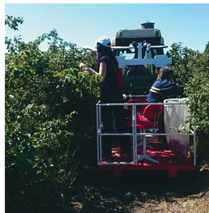
Рис. 10. Опытный образец варианта модульной машины для сбора масличной розы Fig. 10. Prototype of the modular machine variant for harvesting oil-bearing rose flowers
