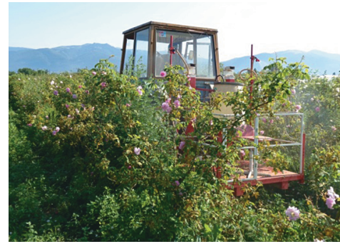
Рис. 8. Опытный образец варианта модульной машины для опрыскивания роз Fig. 8. Prototype of the modular machine variant for spraying roses
