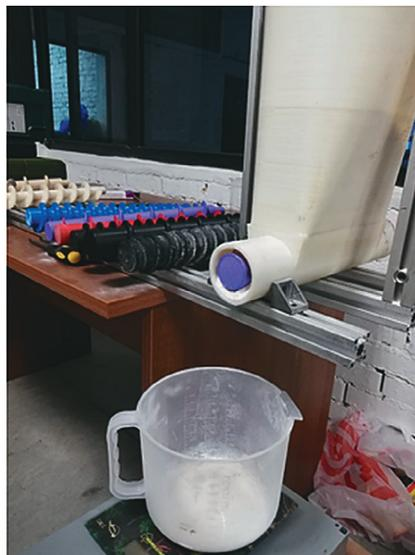
**Рис. 2. Экспериментальная установка для лабораторного исследования дозирования кормовых добавок:**
