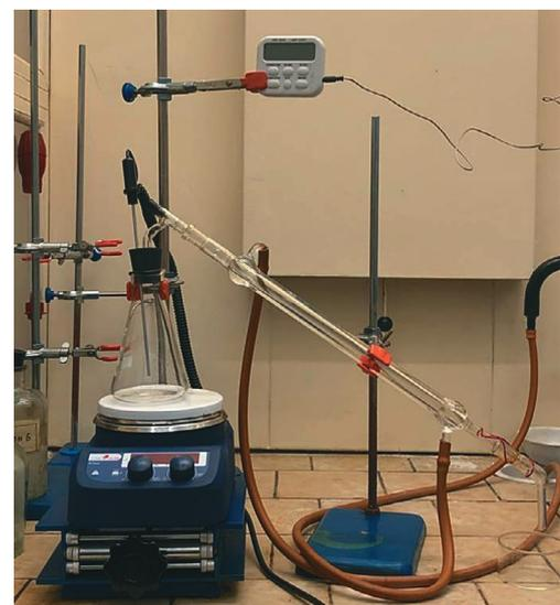
Рис. 2. Экспериментальная установка, обеспечивающая синтез поверхностно-активных веществ из технического жира:
