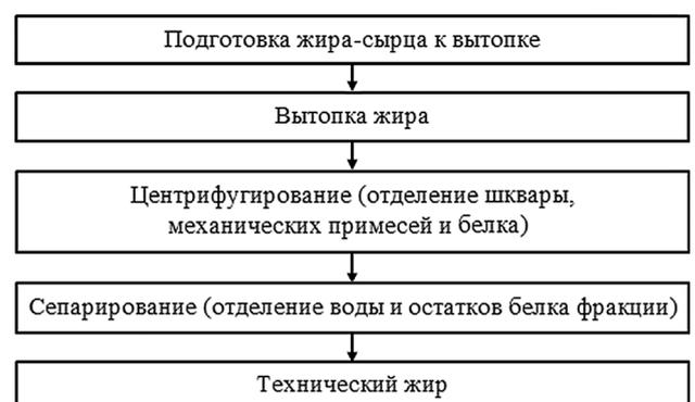
Рис. 1. Технологическая схема переработки жира-сырца в технический жир
