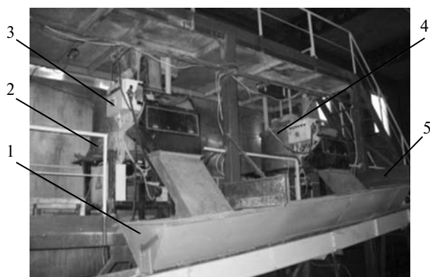
Рис. 2. Общий вид линии с экспериментальными дражировщиками: 1 — транспортер; 2, 4 — дражировщики; 3 — пульт управления дражировщиком; 5 — сушка дражированных семян
