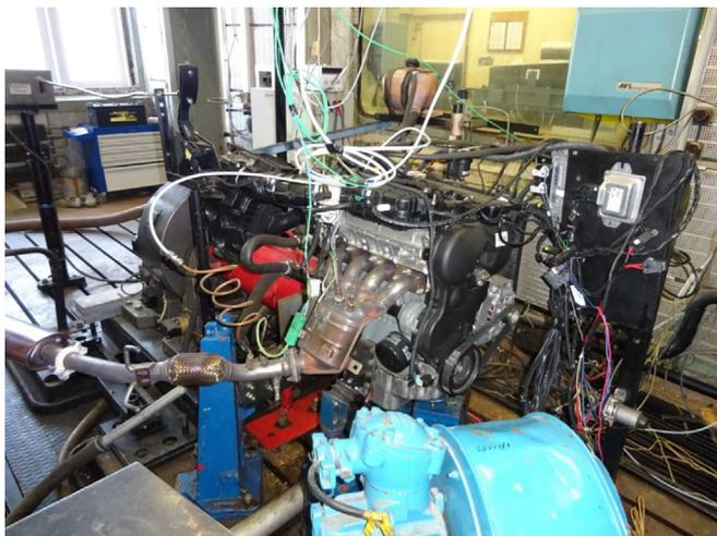
Рис. 1. Двигатель ВАЗ-11194 на моторном стенде
