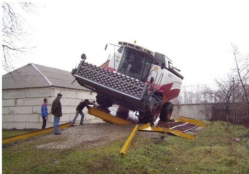
Рис. 1. Определение угла поперечной статической устойчивости: а – по ГОСТ 12.2.002-91 (эксперимент); б – по ГОСТ 33691-2015 (расчёт)
