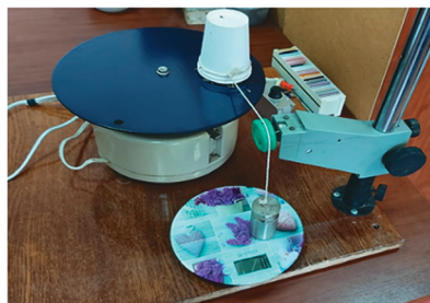
Рис. 1. Испытательный стенд по определению коэффициента трения скольжения:
