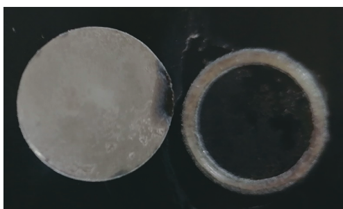
Рис. 4. Испытание адгезии образца из стали 09Г2С Fig. 4. Adhesion test of a sample of steel 09G2S
