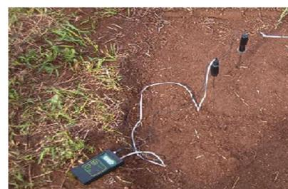
Рис. 2. Измеритель влажности почвы TP 46908
