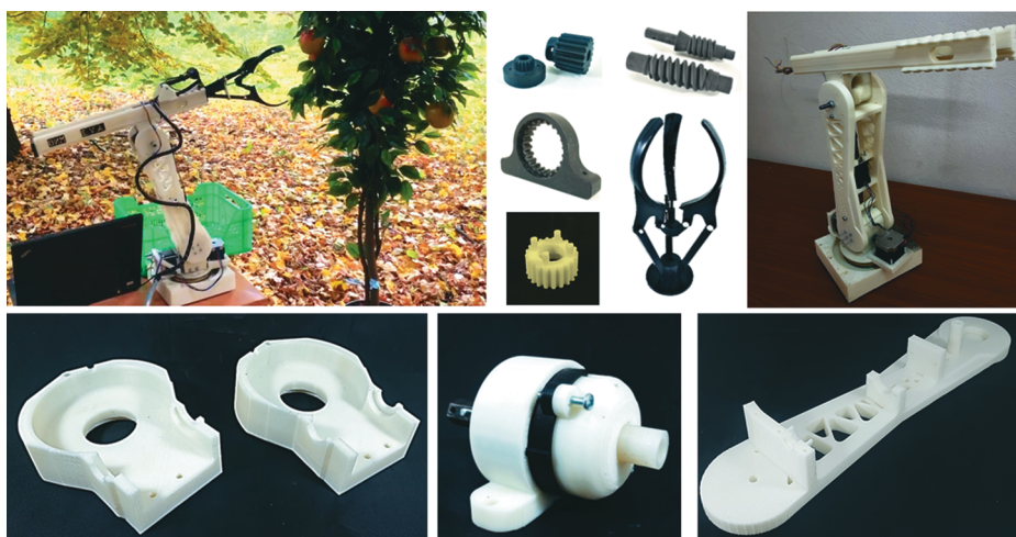
Рис. 1. Детали руки-манипулятора для автоматизированной платформы сбора плодовых культур, изготовленные 3D-печатью из полимерных материалов
