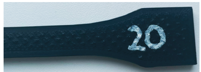
Рис. 6. Дефекты печати образца Fig. 6. Sample printing defects
