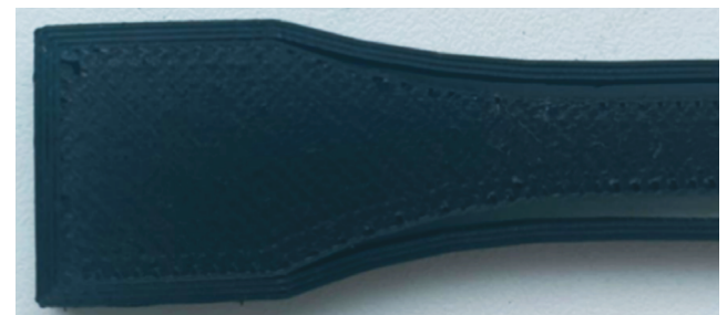
Рис. 7. Отслаивание стенок образца Fig. 7. Peeling of the sample walls
