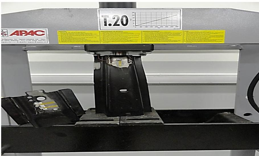
Рис. 1. Стойка и компенсационный элемент в испытательной машине ZD 10/90
