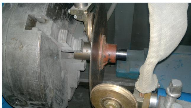
**Рис. 4. Приспособление для закрепления диска сошника в токарном станке при упрочнении**
