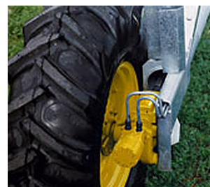
Гидропривод вращательного действия (TL irrigation)
