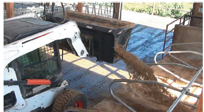
Рис. 3. Ковш с донным транспортером для подсыпки песка Mench 1400
