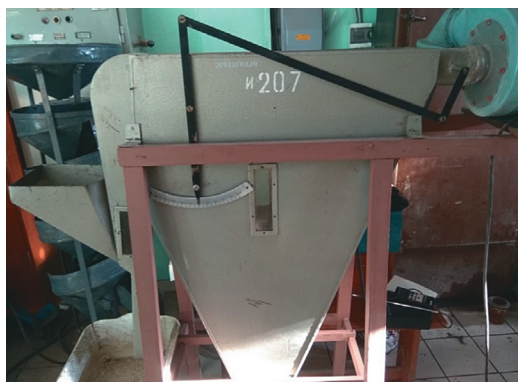
Рис. 2. Общий вид лабораторной установки по определению аэродинамических свойств гранул ТМУ:
