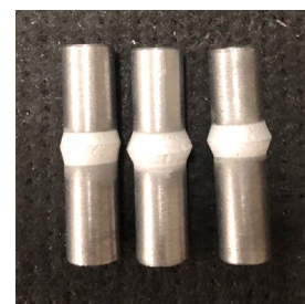
Рис. 2. Заготовка образцов после напыления
