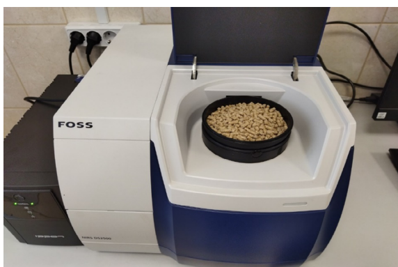
Рис. 1. Прибор Foss NIRS2500 с образцами комбикорма
