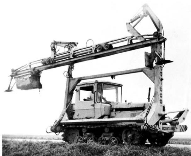
Рис. 1. Каналоочиститель РР-303 на базе трактора ДТ-75
