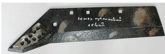
Рис. 3. Общий вид опытного лемеха из стали 40Х
