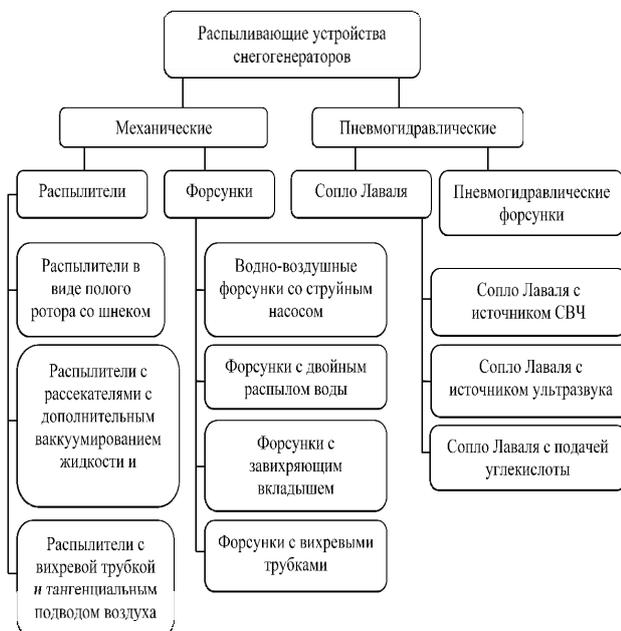
**Рис. 2. Классификация распыливающих устройств снегогенерирующих установок**
