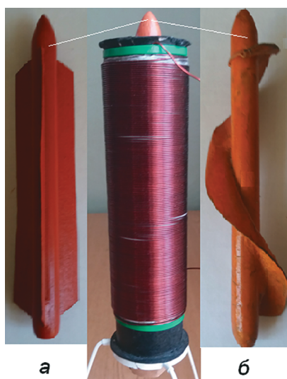
Рис. 3. Усовершенствованный соленоид с внутренней концентрической вставкой:
