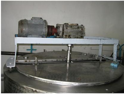
Рис. 1. Емкость с приводом перемешивающего устройства
