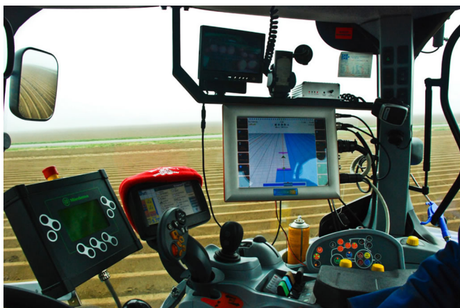
Рис 2. Система управления компьютеризированным трактором
