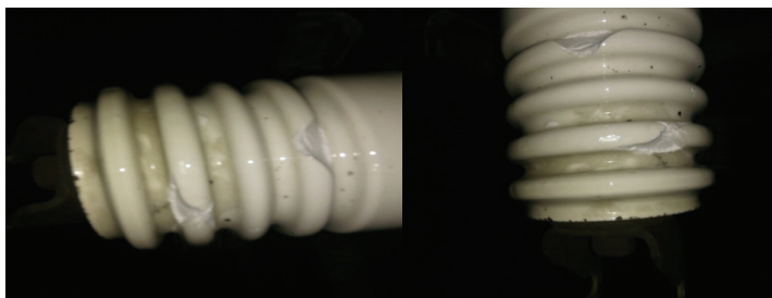
Рис. 3. Сколы на теле фарфорового изолятора
