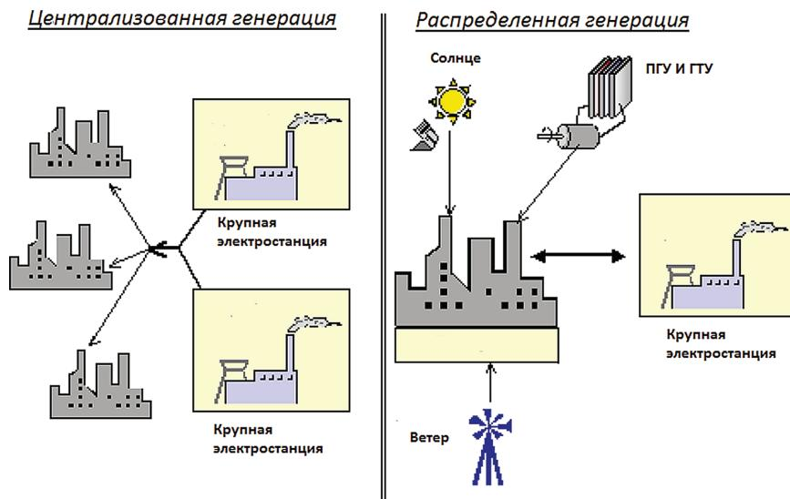
Рис. 1. Централизованная и распределенная генерация
