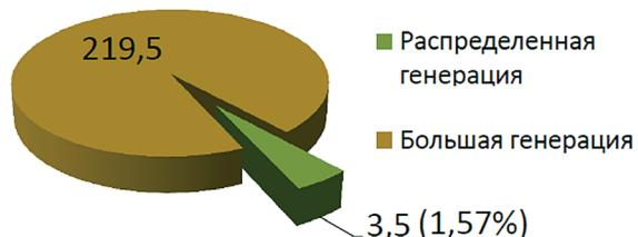
Рис. 2. Установленная мощность генерирующего оборудования в России, ГВт
