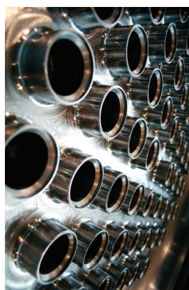
Рис. 2. Оконцовки трубок трубного пучка и соединение трубок с трубной доской
