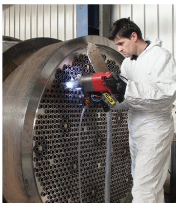
Рис. 2. Оконцовки трубок трубного пучка и соединение трубок с трубной доской
