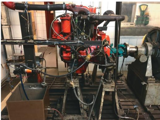
**Рис. 2. Экспериментальный стенд для оценки методов подачи спирта в ДВС**
