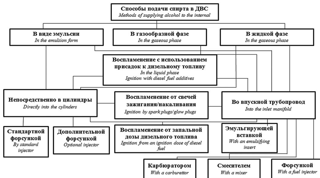
**Рис. 1. Методы подачи спирта в двигатель внутреннего сгорания**
