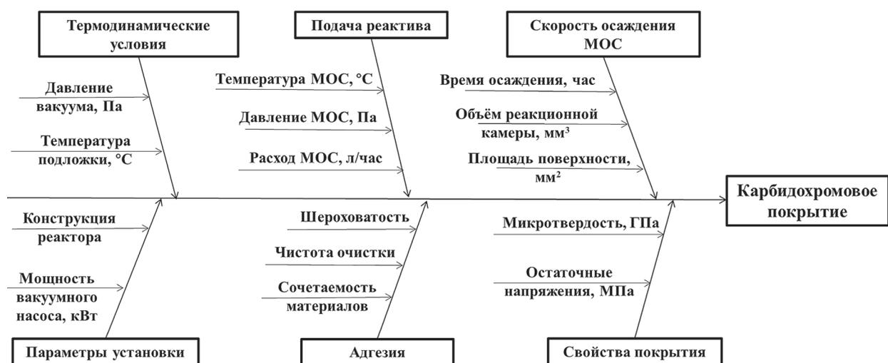
Рис. 1. Факторы, влияющие на осаждение карбидохромового покрытия
