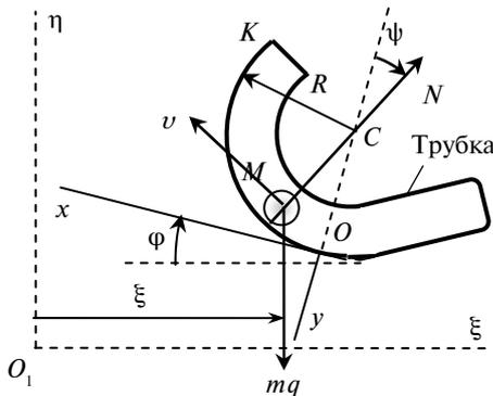
Рис. 3. Схема движения чувствительного элемента в трубке, изогнутой по окружности
