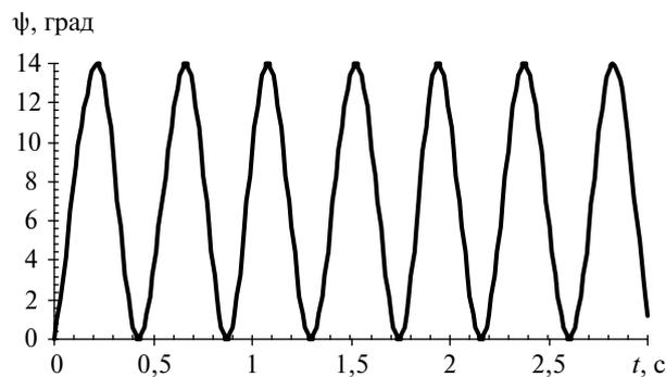
Рис. 6. График движения шарика по трубке, изогнутой по окружности  $R = 50$  мм с ускорением  $1,2$  м/с<sup>2</sup> и  $\varphi_0 = 0^\circ$ , при горизонтальном беге быка
