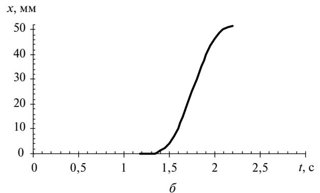
Рис. 2. Графики перемещения шарика по трубке с коэффициентами трения  $\mu = 0$  (а) и  $\mu = 0,1$  (б)
