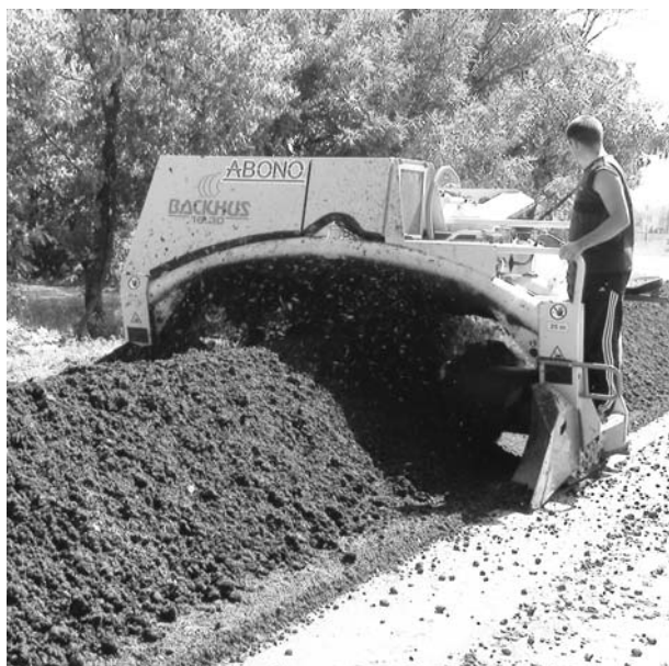
Рис. 7. Ворошитель СВБ16.30 для перебуртовки компостной смеси
