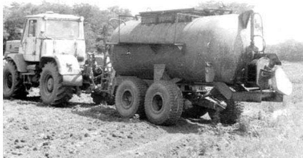
Рис. 5. Технологическая машина для транспортировки и внесения жидких и полужидких КОУ
