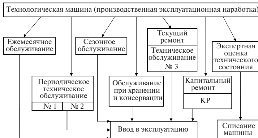
Рис. 2. Система планово-предупредительного ремонта
