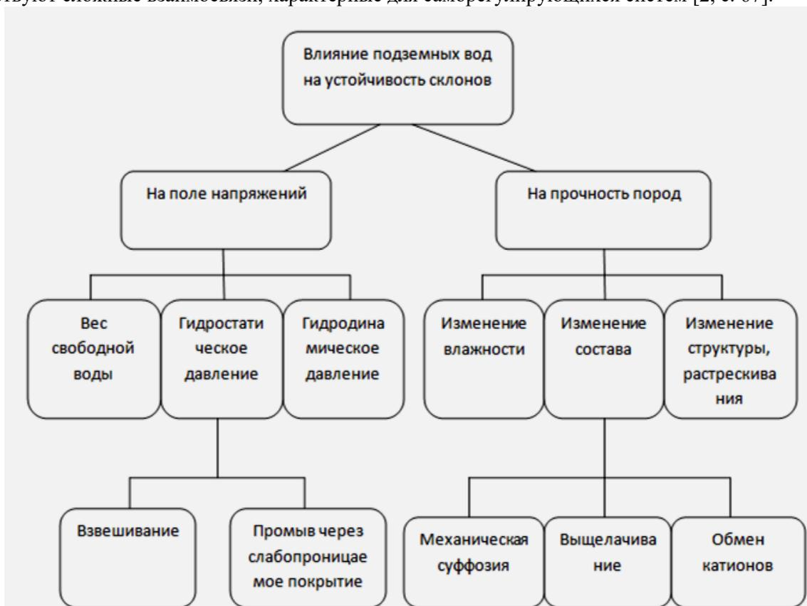
**Рисунок 1. Схема влияние подземных вод на устойчивость склонов**
